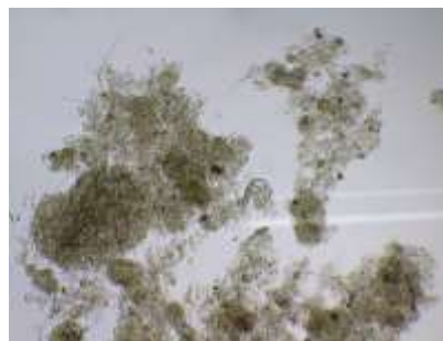
対策を行い、糸状菌の発生を抑制している汚泥
